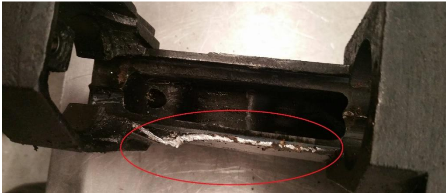
Figura 33 - Corpo do vaso danificado
