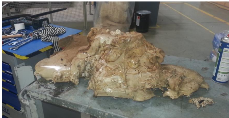
Figura 32 - Derrame de cola em estado sólido
