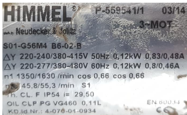
Figura 36 - Chapa de características do motor responsável pelo movimento de rotação do rolo do vaso da cola.
