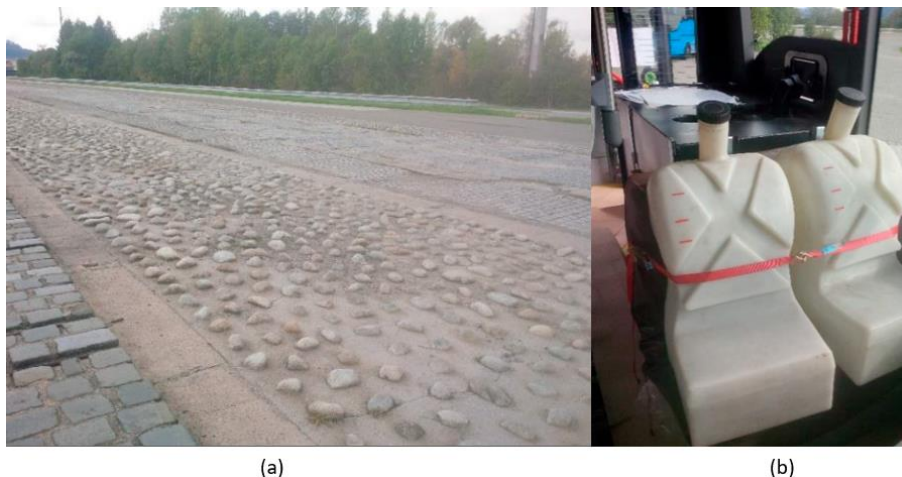
Figura 40- Ensaio à fadiga de estrutura de autocarro [12]. (a) Pista ensaio acelerado à fadiga TATRA Trucks® (b) Simulação do peso dos passageiros no veículo
