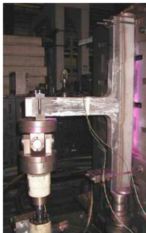
Figura 39- Imagem do ensaio à fadiga de elemento de ligação estrutural [8]
