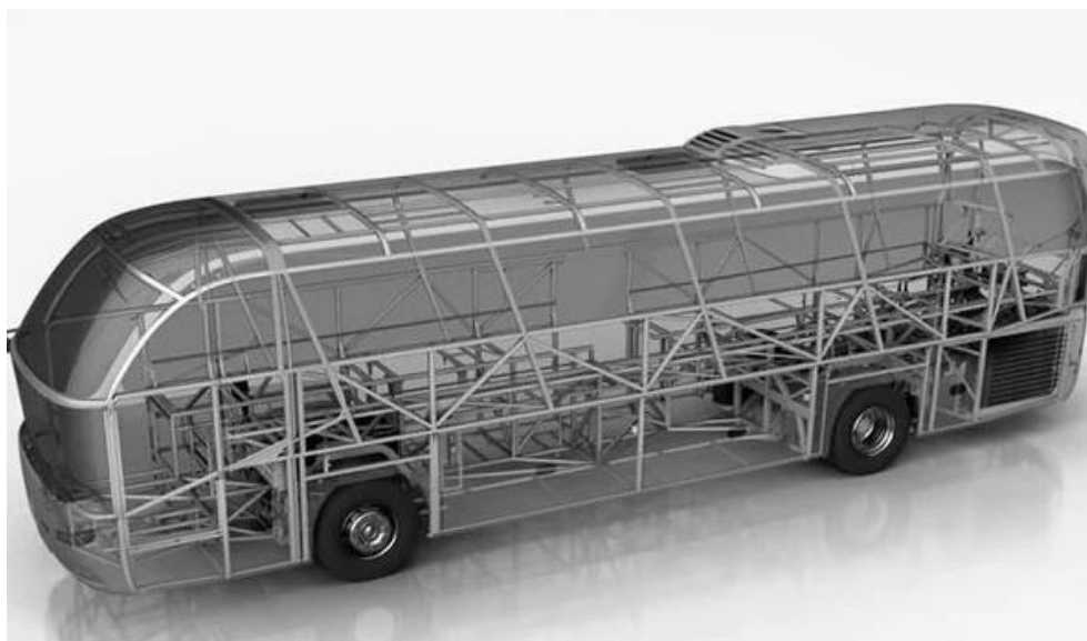
Figura 11- Estrutura Integral em aço [25]
