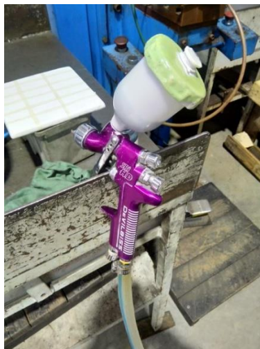
Figura 4.6 Pistola de ar comprimido usada na aplicação do VBT nos provetes vidrados.
