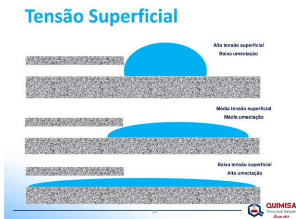
Figura 4.36 Variação do comportamento de um líquido dependendo da tensão superficial [13].
