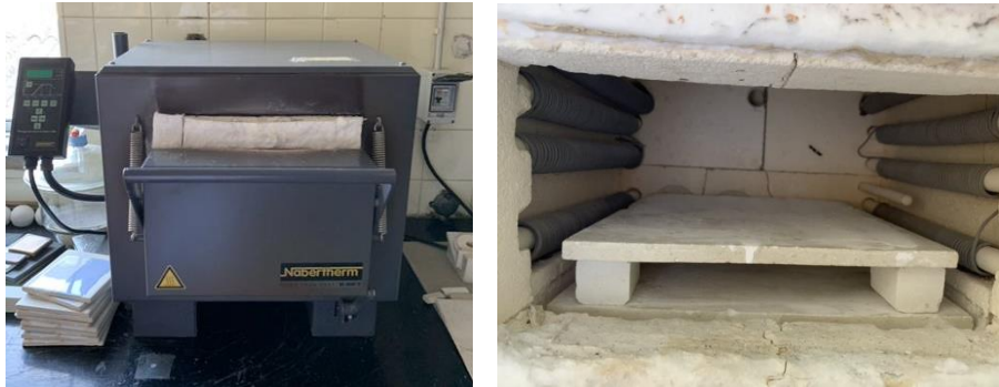
Figura 4.33 Forno elétrico (exterior e interior)
