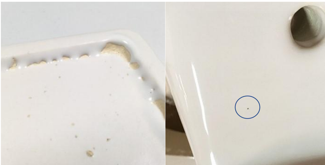
Figura 2.10– Defeitos do produto final: ausência de vidrado (à esquerda) e ponto negro devido à presença de ferro (à direita).
