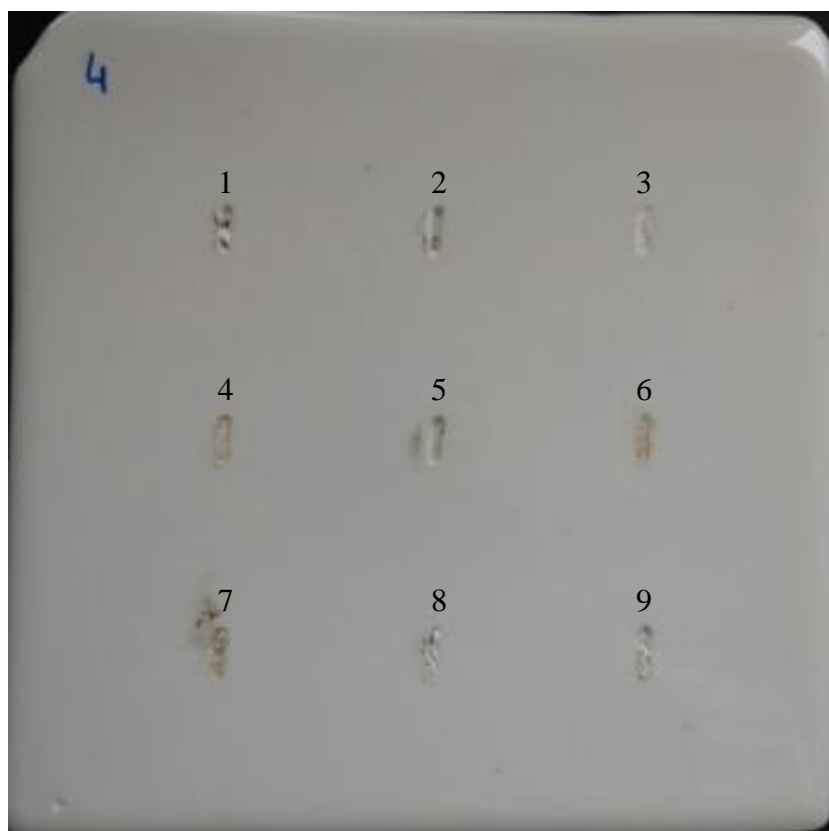
Figura A.18 – Provete D dos ensaios com VBT branco com borato de zinco com PL969 não diluído.
