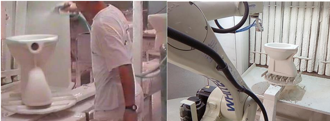
Figura 2.7 – Processo manual de vidragem (à esquerda) [adaptado [6]] e processo de vidragem com braço mecânico (à direita) . [7]
