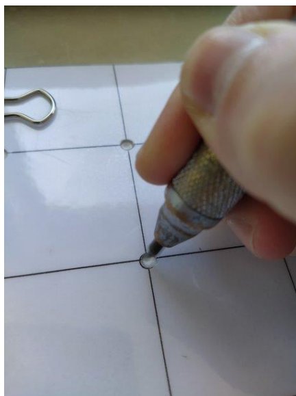
Figura 4.3 Simulação de defeitos com um “molde” de cartão plastificado, utilizando, neste caso, a caneta pneumática.
