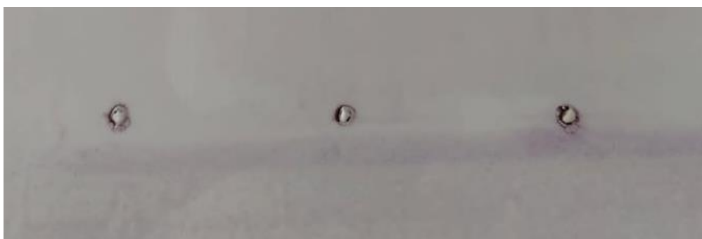
Figura 4.19 Ensaios 7, 8 e 9 do provete A do ensaio de VBT com PL960 diluído, após teste de fendilhagem.
