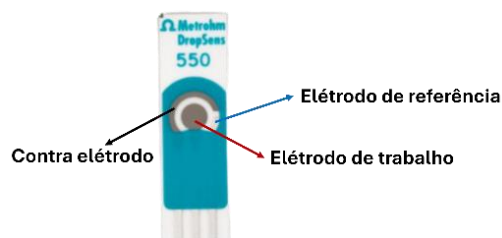
Figura 15 – Elétrodo descartável de platina, constituído por um elétrodo de trabalho, um contra elétrodo e um elétrodo de referência.
