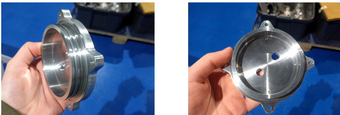
Figura 4.18: Maquinação da tampa traseira da secção 2 da estrutura externa.
