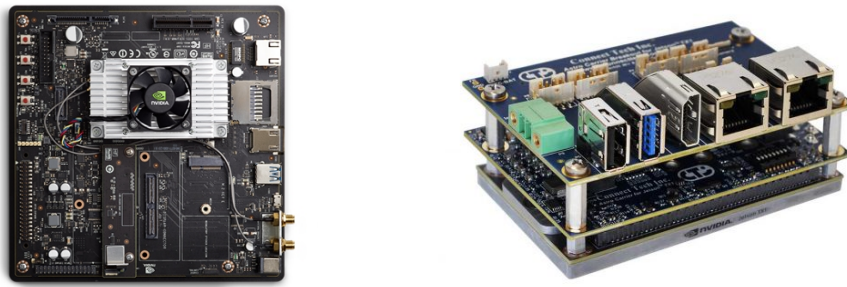
Figura 3.14: Placas de acesso às interfaces do módulo da NVIDIA: à esquerda Nvidia Developer Kit [95] e à direita Astro Carrier [96].
