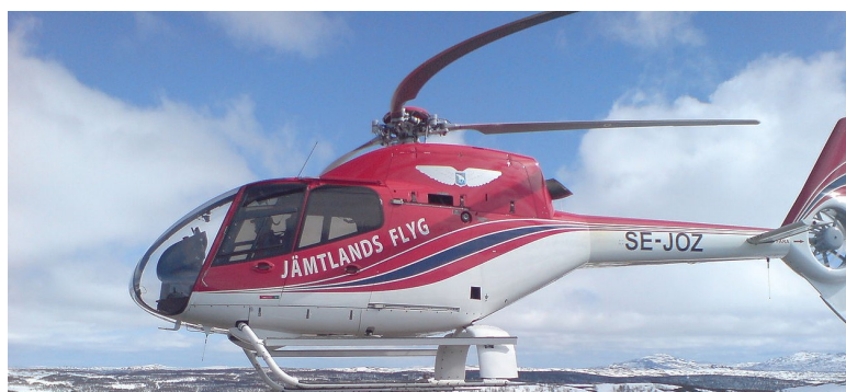
Figura 2.9: Efeito de distorção de um objeto em movimento captado através de um obturador Rolling Shutter [23].
