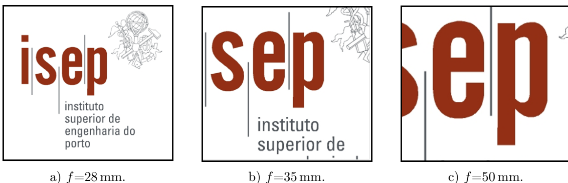
Figura 2.11: Demonstração do campo de visão de uma imagem para diferentes valores de distância focal [24].
