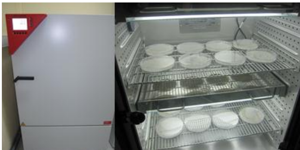
Figura 2.1 - Câmara de germinação da BINDER, modelo KBWF 240.
