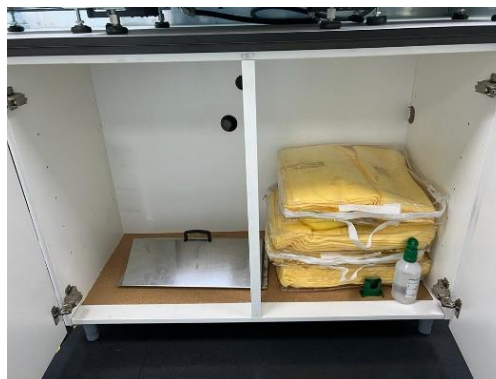
Figura 4. 30 Armário com mantas anti derrame e tampa de um banho
