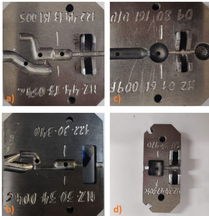
Figura 62 – Molde inferior de injeção de zamak a) Manivela pequena; b) Manivela grande; c) Cilindro \varnothing 7 mm (6,5 mm); Esfera \varnothing 7 mm.
