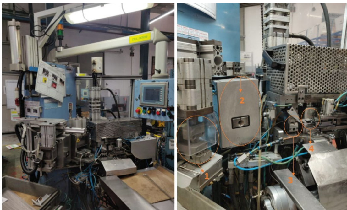
Figura 50 – Máquina semiautomática de 1ª injeção do terminal de zamak ; (1) Dispositivo de aparar cabo (corte mecânico); (2) Dispositivo de decapar cabo; (3) Dispositivo de fazer flor; (4) Molde 1ª injeção de zamak
