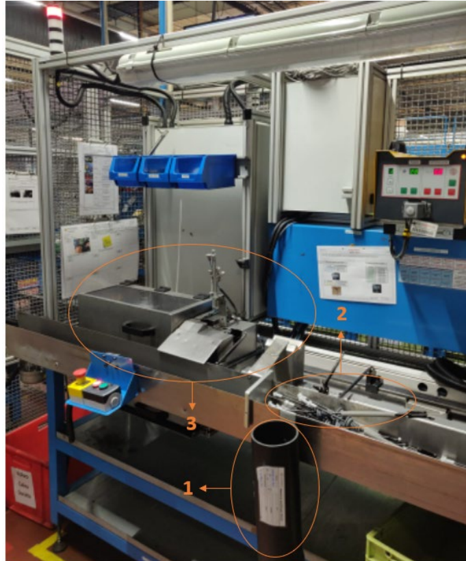
Figura 43 - Posto de introduzir e aparar cabo metálico; (1) – Cabo metálico; (2) – Subconjunto de espiral; (3) – Dispositivo de corte elétrico
