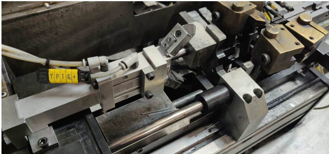
Figura 96 - Novo sistema de corte elétrico aplicado na linha de montagem
