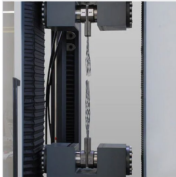
Figura 31 - Ensaio de tração realizado a um cabo de aço [118]
