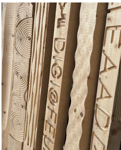
Figura36 Registo pessoal- acabamentos da fresa.
