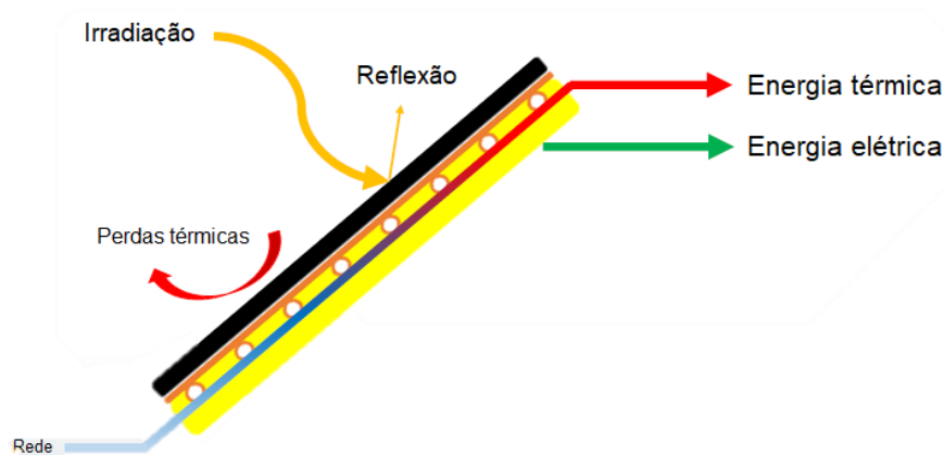
Figura 2.12 Esquema representativo dos fluxos energéticos de um coletor solar híbrido [adaptado de 14].
