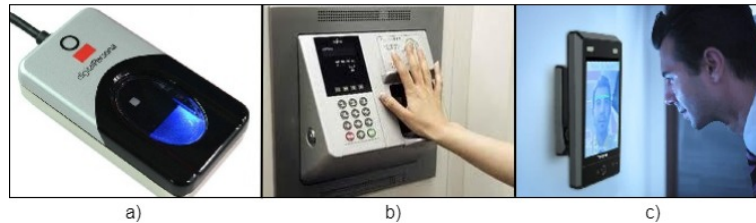
Figura 2.20: a) Leitor de impressão digital - b) Leitor de impressão da mão e c) Leitor de reconhecimento facial [46][47][48]
