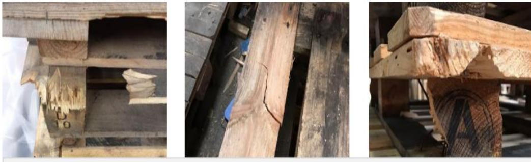
Figura 14: Exemplos de paletes não conformes com as especificações técnicas (Fonte: BA Glass)
