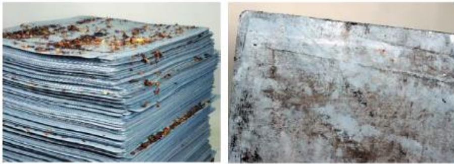
Figura 17: Exemplos de intercalares não conformes com as especificações técnicas (Fonte: BA Glass)
