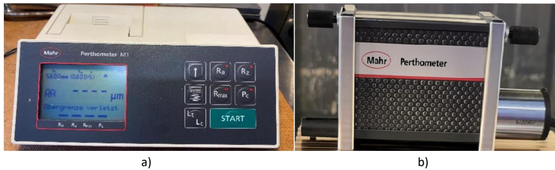
Figura 38 – a) Rugosímetro Mahr Perthometer M1 ; b) Apalpador montado no bloco
