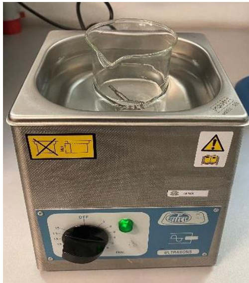
Figura 31 – Limpeza com acetona em equipamento de ultrassons
