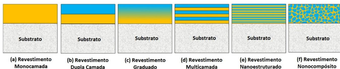
Figura 25 – Configurações para revestimentos depositados em ferramentas de corte (Caliskan et al., 2017)
