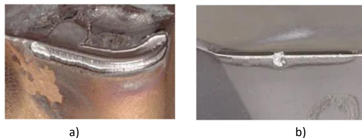
Figura 6 - Desgastes possíveis da ferramenta de corte: (a) flanco e (b) lascagem (Sandvik, 2017, 2022a)
