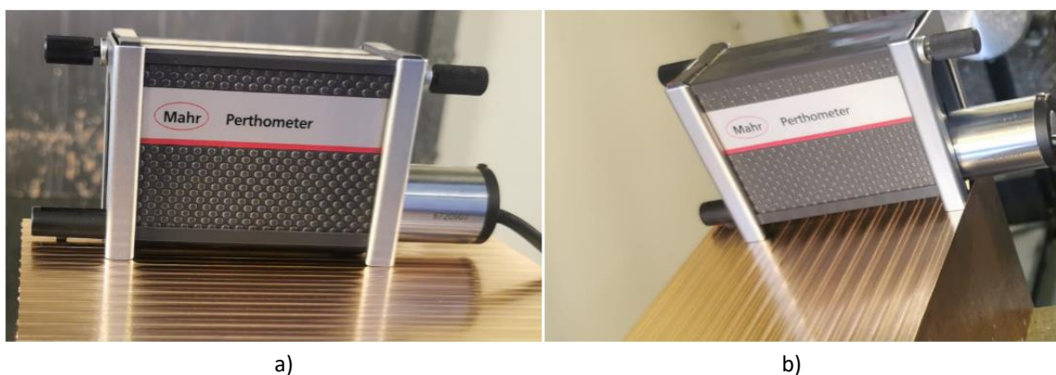
Figura 39 – a) Apalpador montado longitudinalmente; b) Apalpador montado transversalmente
