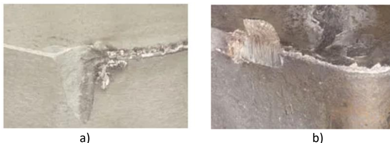
Figura 7 - Desgastes adesivo: (a) tipo entalhe e (b) aresta postiça (Sandvik, 2017, 2022a)
