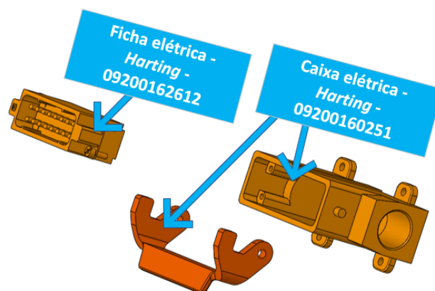
Figura 51 - Ficha elétrica, destinada à alimentação dos sensores de posição
