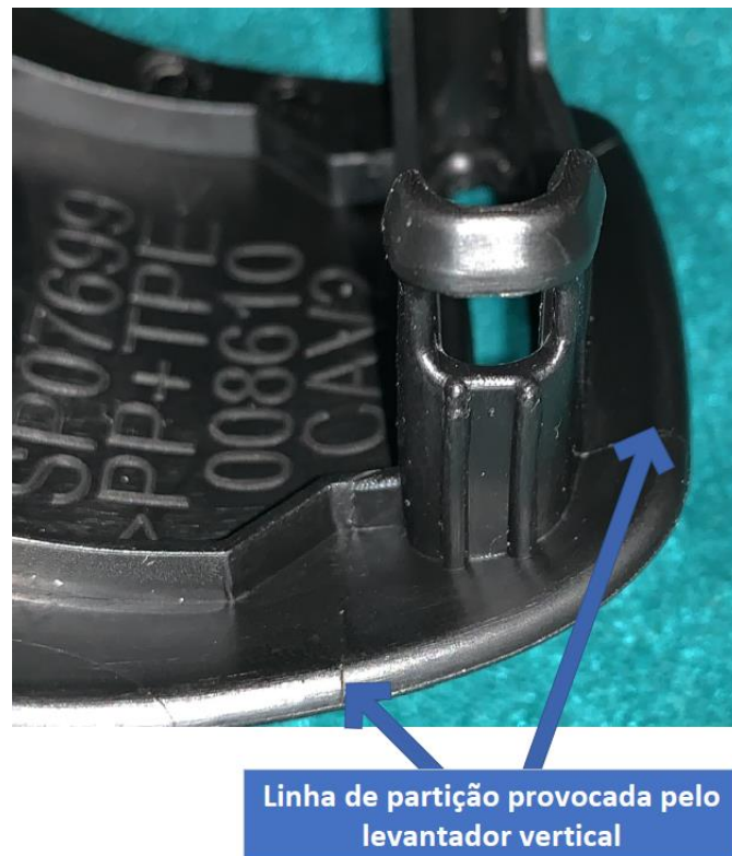
Figura 257 - Marcas criadas na peça pelos levantadores verticais
