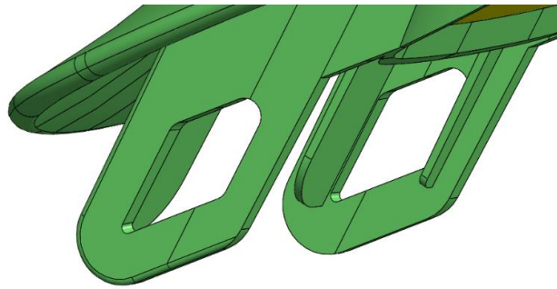
Figura 104 - Geometria dos furos da base da peça, tal como o cliente final deseja
