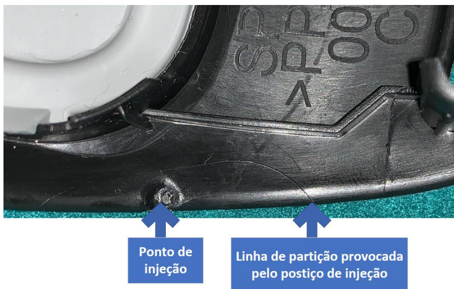
Figura 256 - Pormenor do local de injeção
