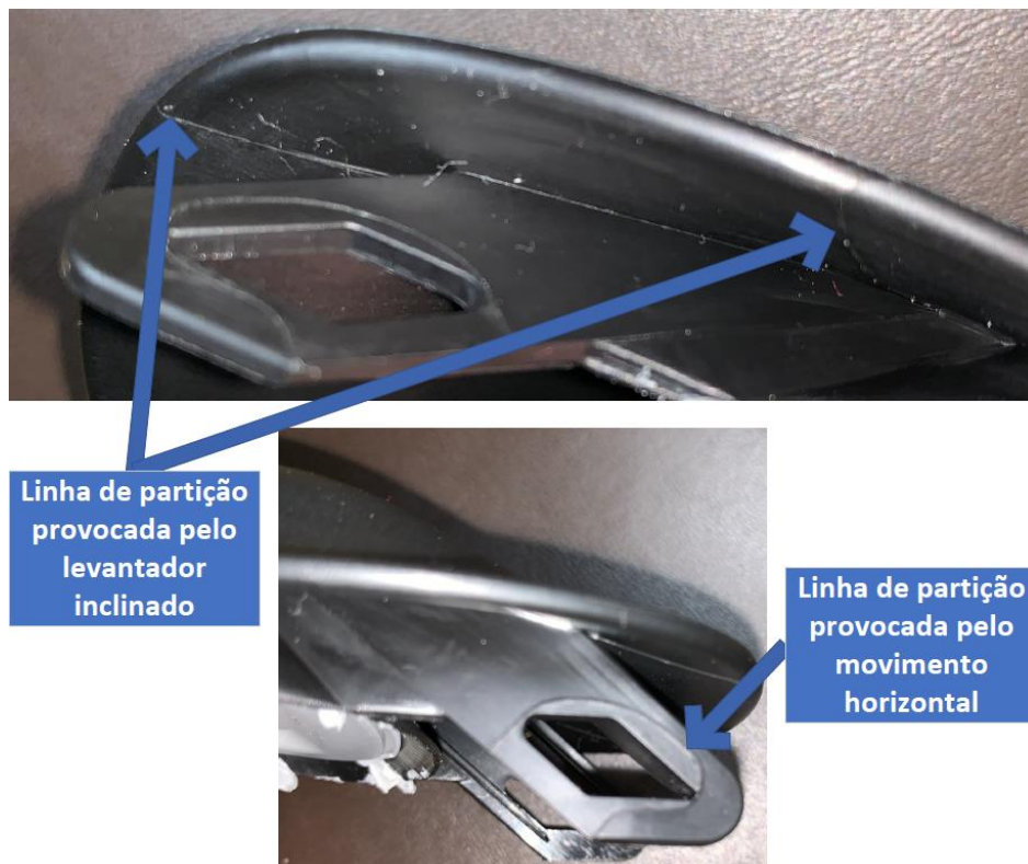
Figura 258 - Marcas na peça criadas pelos movimentos horizontais e levantadores inclinados
