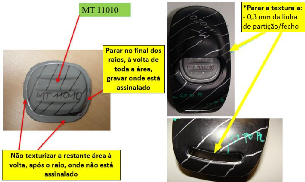
Figura 251 - Descrição das zonas de gravação e tipo de acabamento na parte da peça em PP e em HDPE
