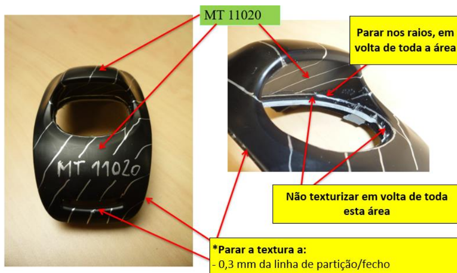
Figura 252 - Descrição das zonas de gravação e tipo de acabamento na parte da peça em PP em maior detalhe
