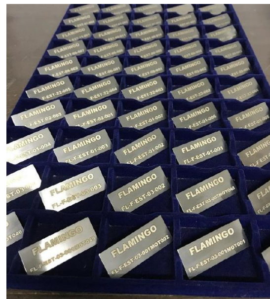
Figura 18 - Chapas de códigos funcionais para identificação de equipamentos.
