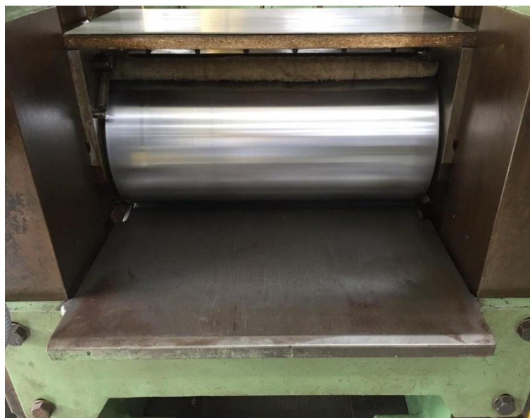
Figura 32 - Área de trabalho do laminador (cilindros sem proteção).
