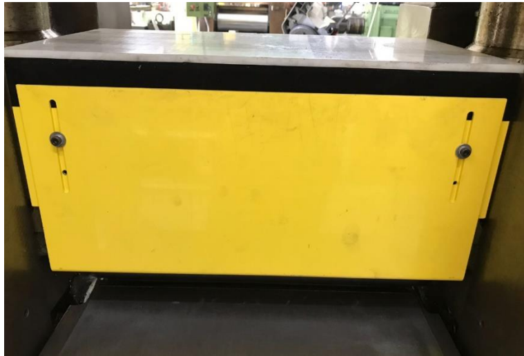
Figura 33 - Barreira de proteção dos cilindros (ajustável).
