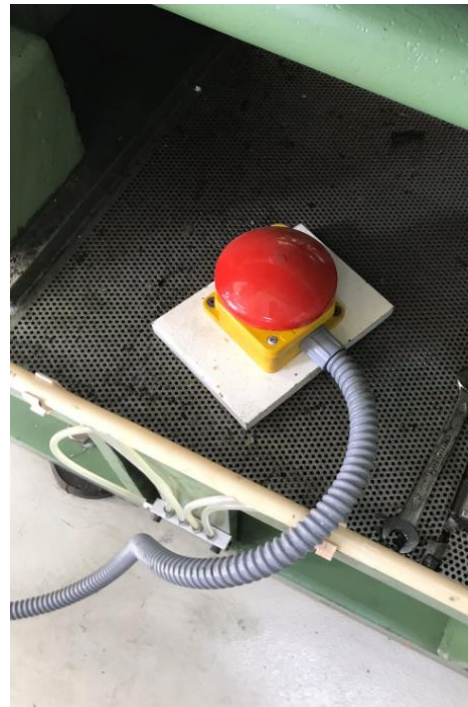
Figura 37 - Botão de emergência.
