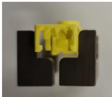
Figura 50 – Posicionamento do conector após a melhoria das garras
