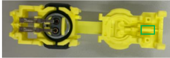
Figura 45 – Zona de contacto do cover com o calcador
