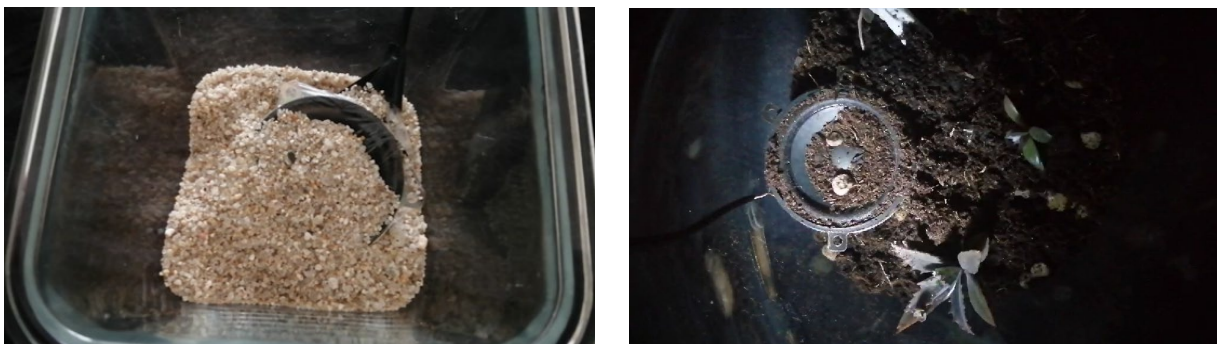
Figura 12 – Testes de diferentes materiais a vibrar sobre um altifalante pequeno
