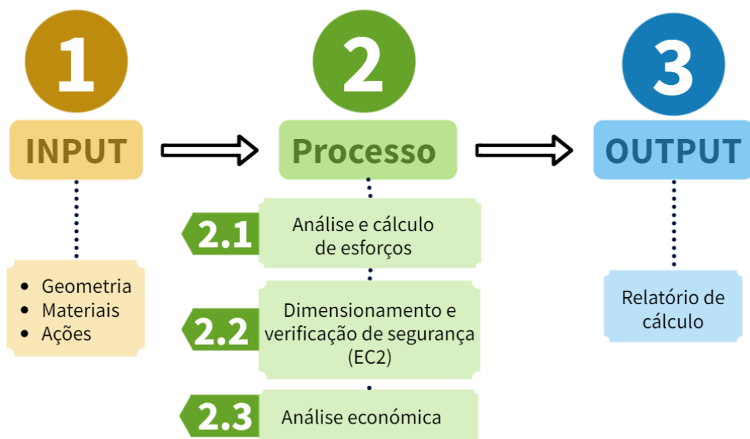
Figura 3.1 – Esquema das 3 fases do processo de cálculo
