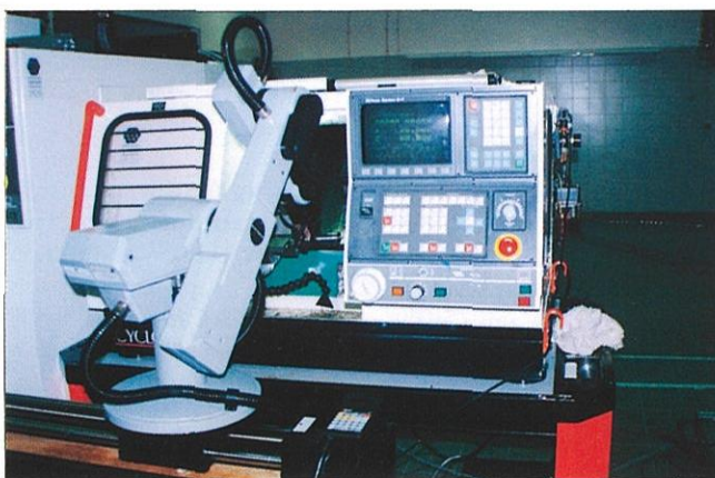
Figura 2 - Parte da Estação de Maquinagem (robot e torno)
