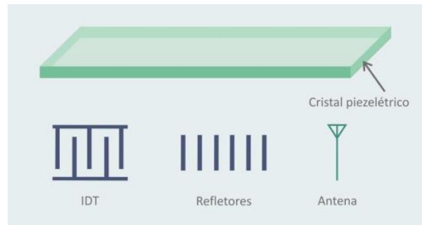
Figura 16 - Componentes de um sensor SAW [33].
