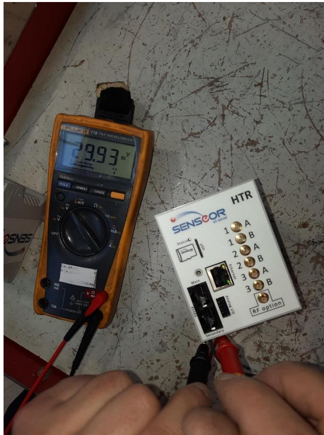
Figura 55 - Transcetor alimentado com 30 Vdc.
