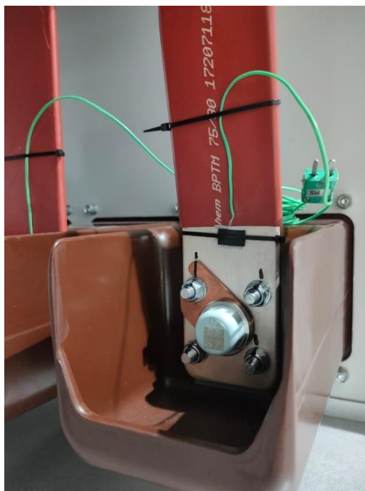
Figura 60 - Termopares utilizados junto à cloche superior.
