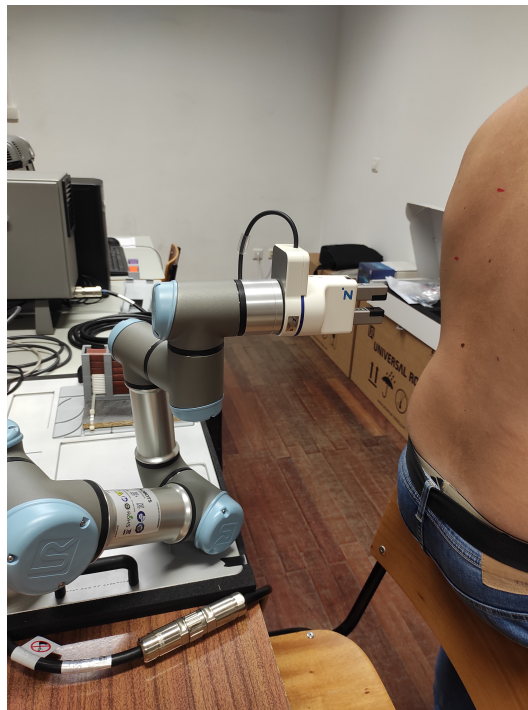
Figura 6.18: Colisão da junta elbow do braço robótico com a bancada onde se encontra instalado, ao tentar alcançar o ponto L4 do paciente 6
