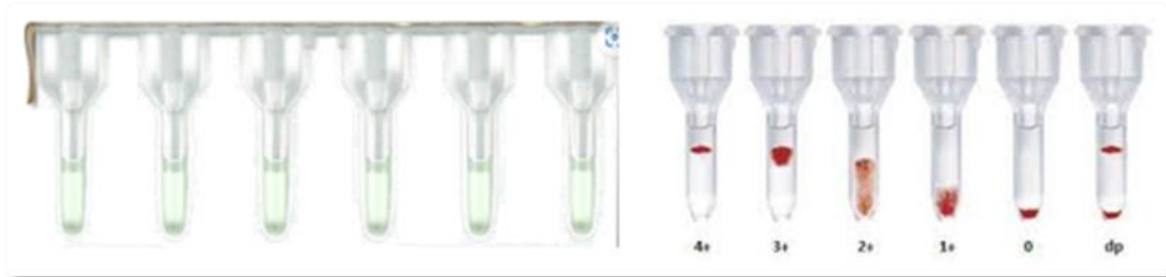
Figura 6. Microtubos antes de serem utilizados (esquerda); diferentes graus de aglutinação possíveis (direita)
