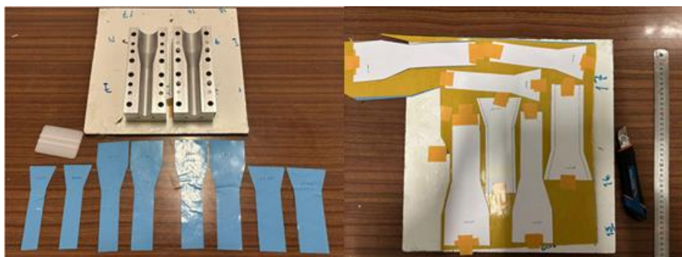
Figura 42 - Recortes do pré-impregnado de carbono/epóxico
