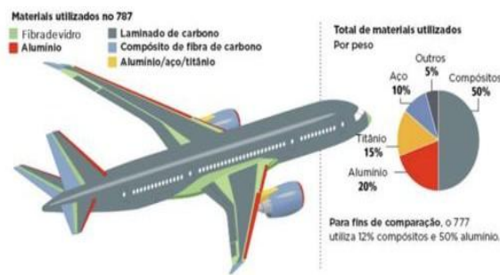
Figura 15 - Composição da estrutura de um Boing 787 [29]
