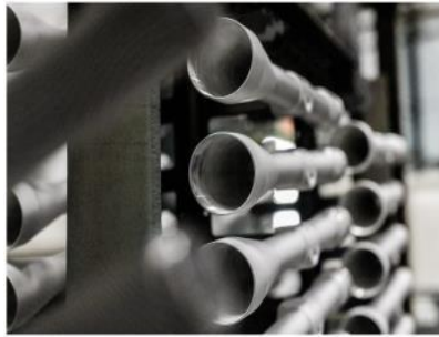
Figura 11 - Ilustração do corpo da mira telescópica após o processo de maquinagem [14]
