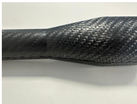
Figura 57 – Defeitos observados no terceiro protótipo
