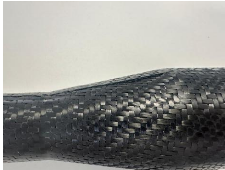
Figura 52 – Defeitos observados no segundo protótipo
