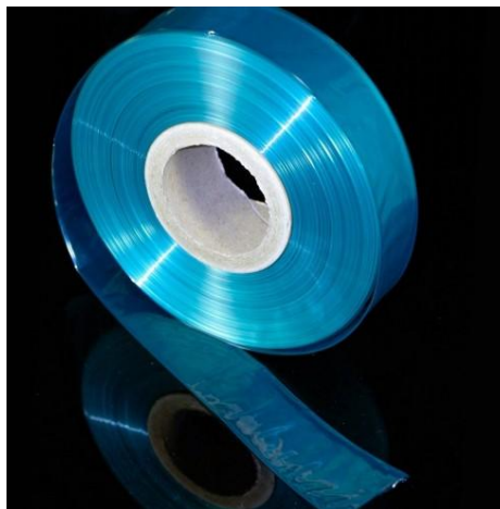
Figura 31 - Saco de vácuo tubular PA205, com 50 \mu m (micrómetros) de espessura e 75 mm de largura (diâmetro de 47,75 mm) [53]
