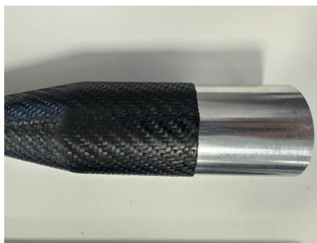
Figura 50 - Defeito identificado - Má adesão entre a matriz epóxica e o inserto metálico da objetiva
