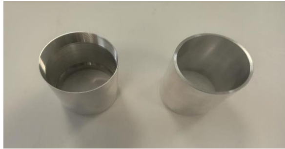
Figura 20 – Inserto totalmente maquinado (esquerda), Inserto por maquinar (direita) [42]
