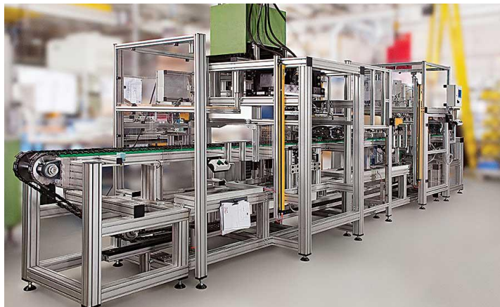
Figura 12: Estrutura em alumínio de linha de produção [37].
