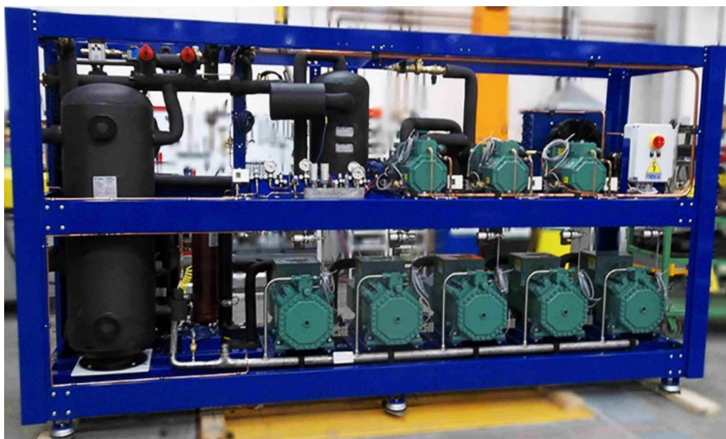
Figura 25: Estrutura em chapa quinada aplicada numa central frigorífica a funcionar com CO 2 como fluido de trabalho [76].
