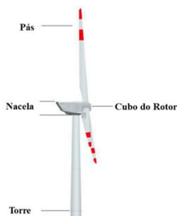
Figura 5: Componentes principais de um aerogerador [23].
