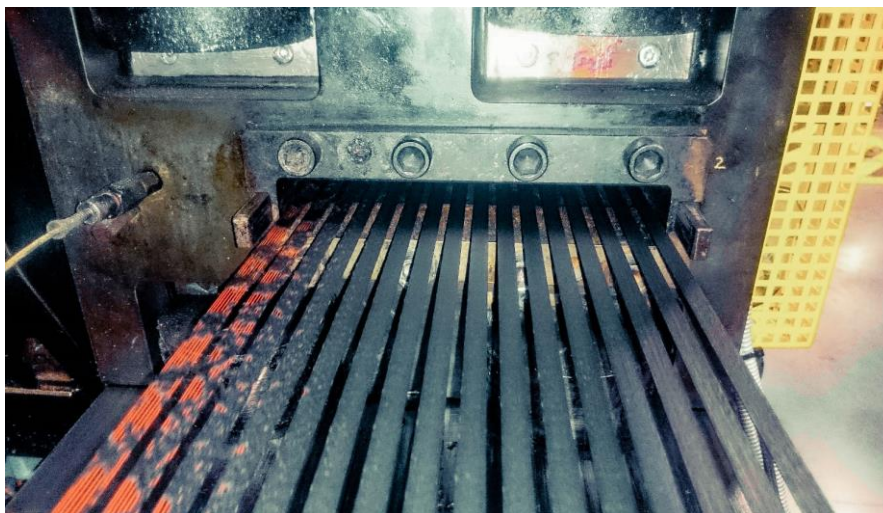
Figura 48 - Produção de cap ply com quatro cintas defeituosas devido à falha de impregnação de borracha.
