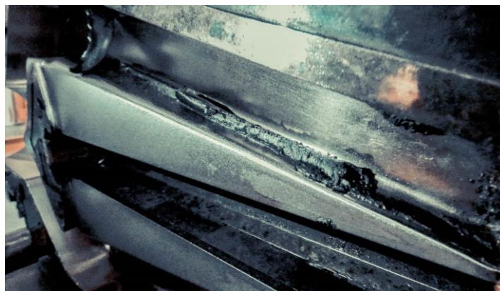
Figura 46 - Composto de borracha vulcanizado nos canais de escoamento do cabeçote.
