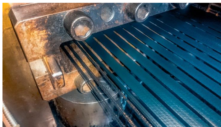
Figura 47 - Presença de duas cintas de cap ply defeituosas devido à existência de aglomerados de composto de borracha na fieira.
