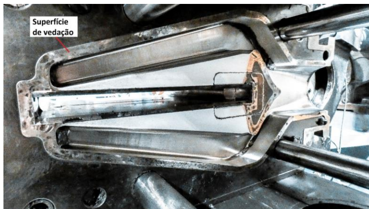
Figura 37 - Pormenor da superfície de vedação no interior do cabeçote.
