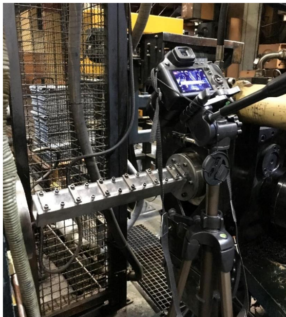
Figura 132 - Provete de ensaio e câmara fotográfica instalados para registo de dados.
