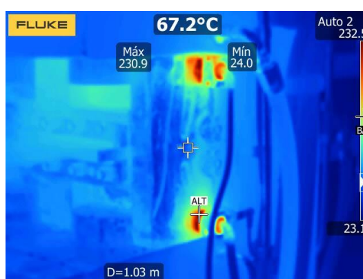
Figura 72 - Imagem termográfica do cabeçote com a Cap strip em funcionamento à velocidade máxima da linha.
