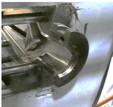
Figura 82 - Elemento de encaixe pertencente ao cabeçote. Permite ligar o cabeçote à bomba de engrenagens.
