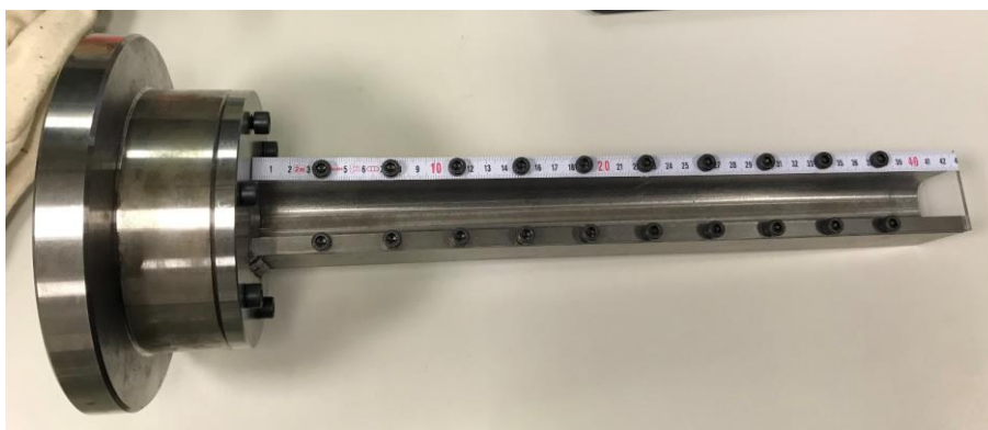
Figura 84 - Equipamento desenvolvido para os ensaios de extrusão.
