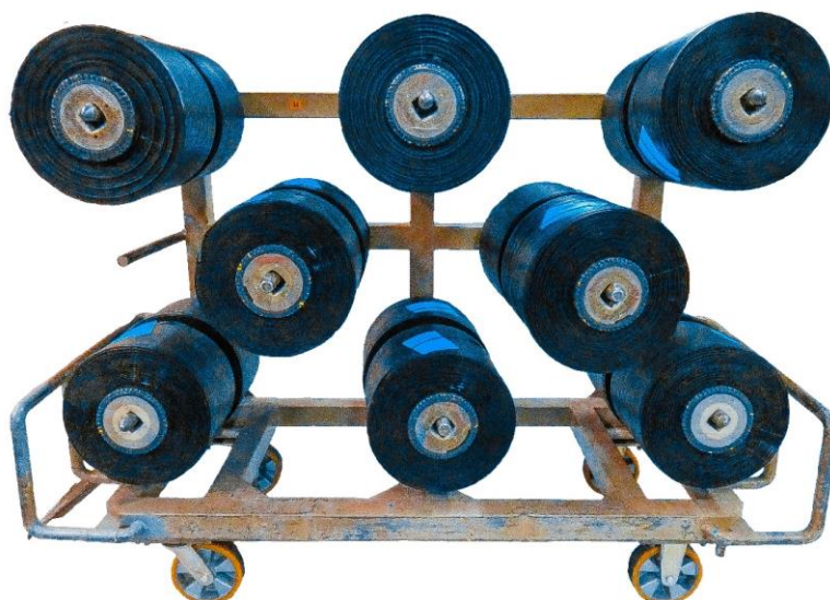
Figura 45 - Carro de transporte com bobinas de cap ply devidamente identificadas.
