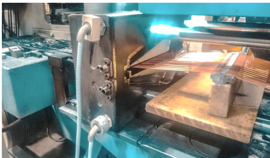
Figura 38 - Demonstração da montagem das cordas na fieira durante a abertura do cabeçote.
