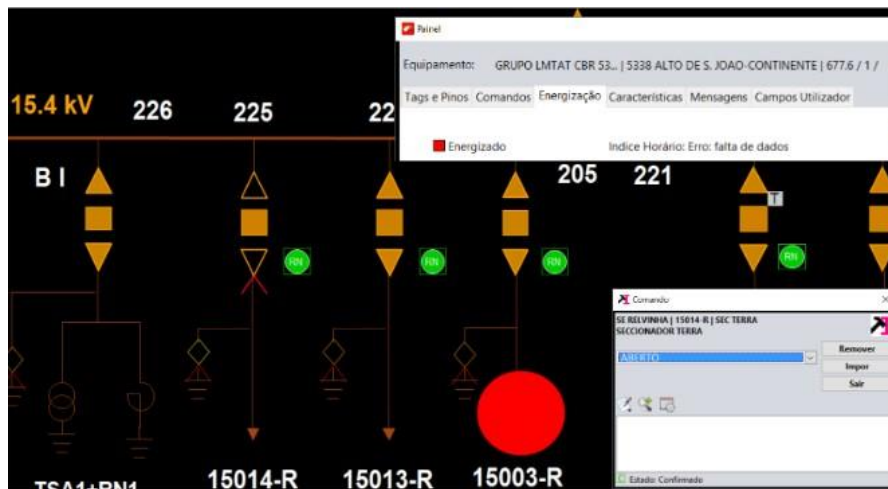
Figura 71 Energização da linha 1 após abertura do disjuntor-terra.
