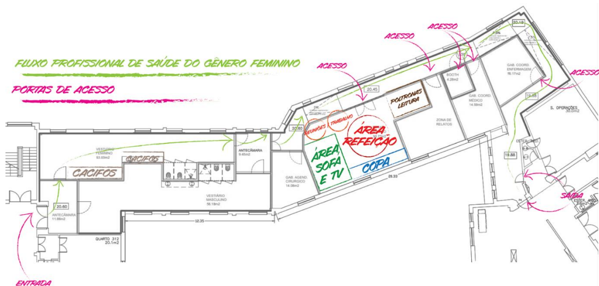
Fig.22 Estudo de fluxo com a tipologia: Profissional de saúde do gênero feminino, entrada nas áreas comuns até área do bloco operatório. (24 de janeiro, 2024)
