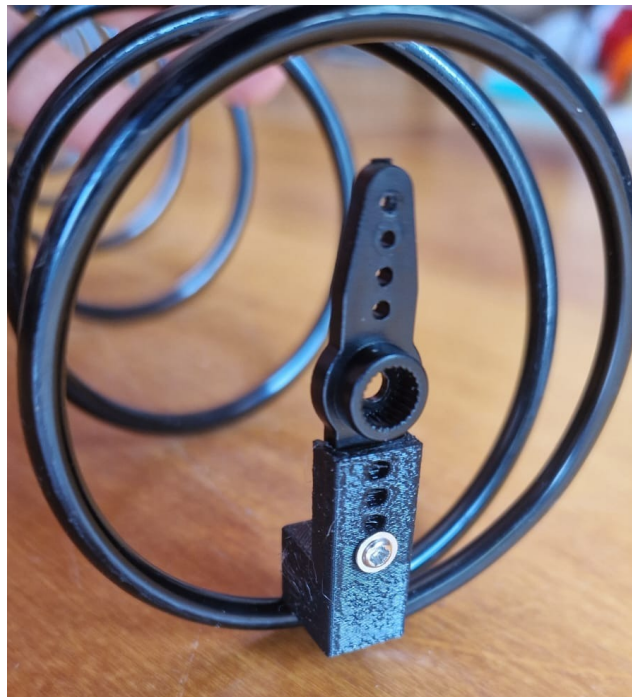
Figura 4.11: Peça final impressa em PETG, montada na mola helicoidal.
