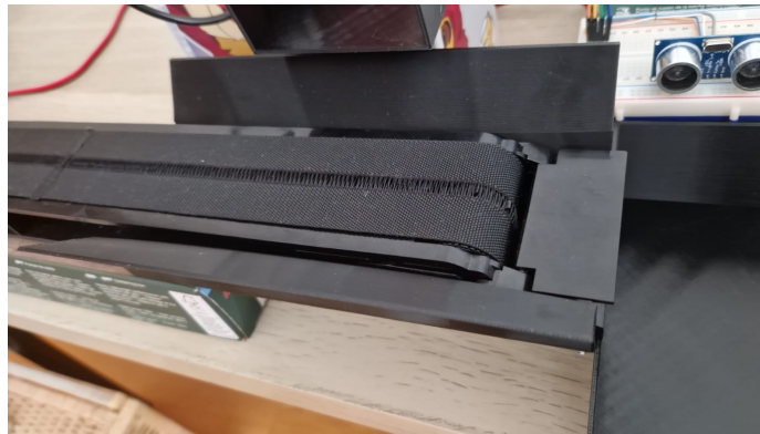
Figura 4.12: Funil de direcionamento impresso em PETG.
