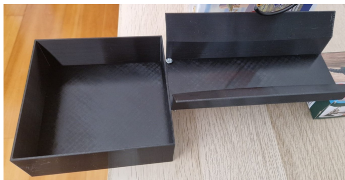
Figura 4.13: Caixa de receção impressa, colocada no fim do tapete rolante.
