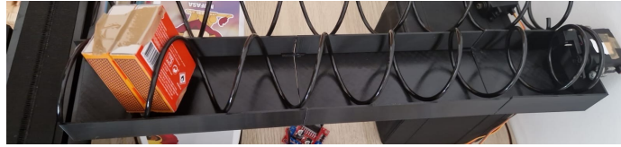
Figura 4.14: Suporte da mola e do motor após impressão e montagem.
