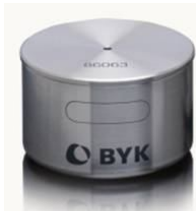
Figura 3.2 – Picnómetro de 50 mL para medição da densidade dos ensaios realizados
