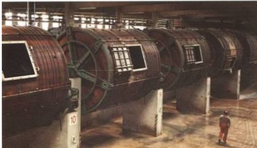
Figura 1.4 – Bateria de fulões de Ribeira e Curtume
