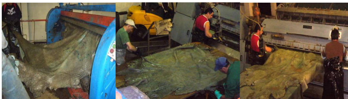
Figura 1.1 – Processo da descarna mecânica [5]
