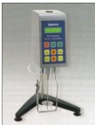
Figura 3.1 – Viscosímetro digital Brookfield LVDV+
