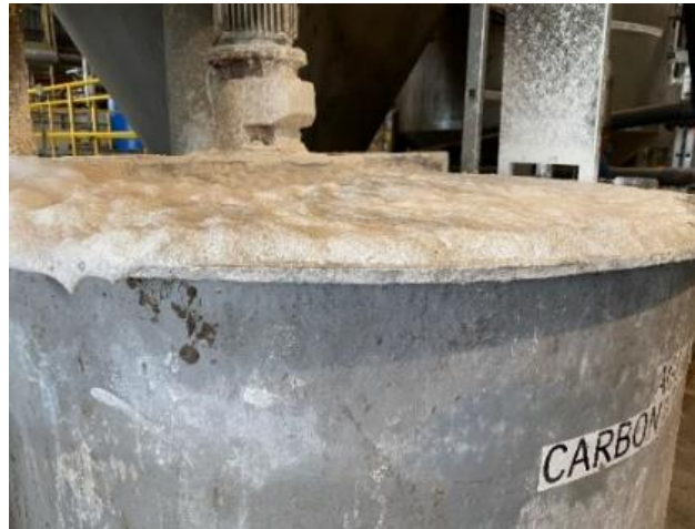
Figura 7.2. Exemplo da formação de espuma no tanque de carbonato de cálcio.
