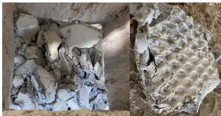
Figura 3.11. Aspeto das lamas depois de prensadas.
