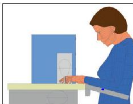
Figura 4 - Apoios de braços fixados no tampo da mesa
