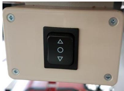
Figura 2 - Botão para regular a altura da mesa de trabalho
