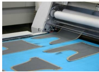
Figura 9 – Submissão das peças ao calor (Termocolagem)
