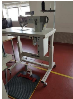
Figura 15 - Máquina de costura regulável em altura
