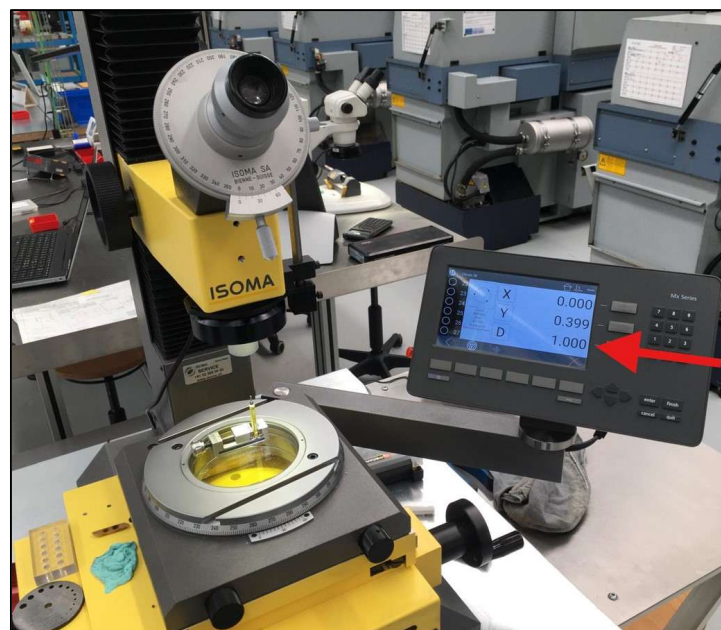
Figura 41 – Medição do calibre de aferição no Microscópio de medição por luneta
