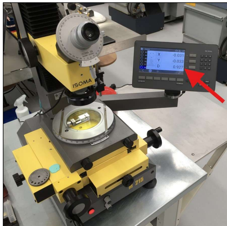
Figura 46 – Medição da dimensão \varnothing 0.930 no microscópio de medição por luneta
