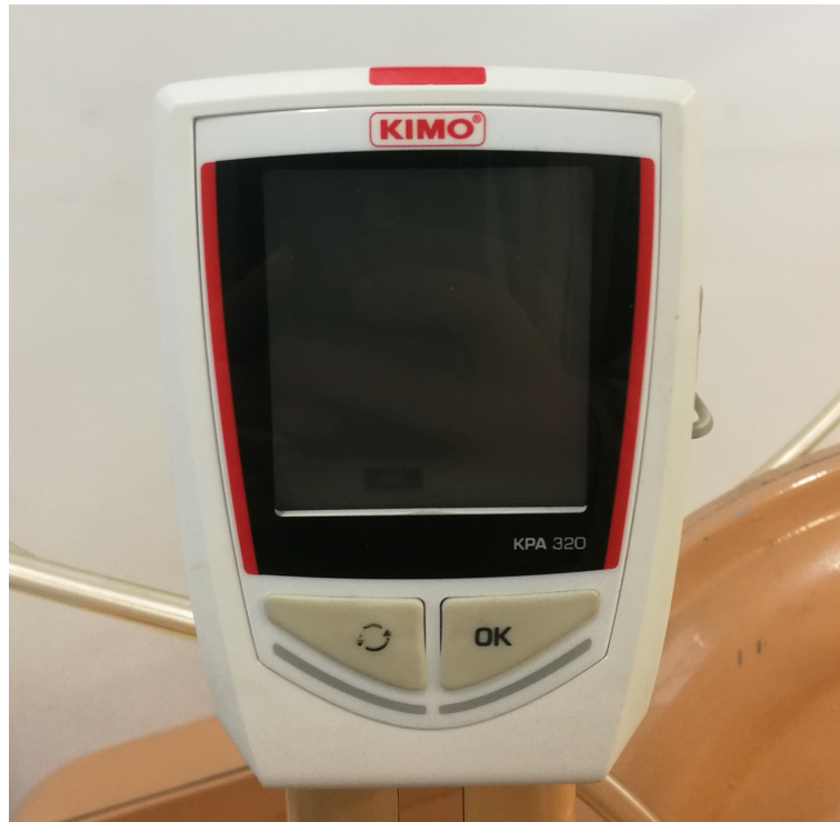
Figura 3.3: Equipamento, KIMO KPA 320, utilizado para leitura dos valores instantâneos de pressão e temperatura ambiente do laboratório
