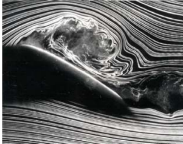
Figura 2.1: Separação do fluido do aerofoil , ocorrendo o efeito de stall (retirado de [1])
