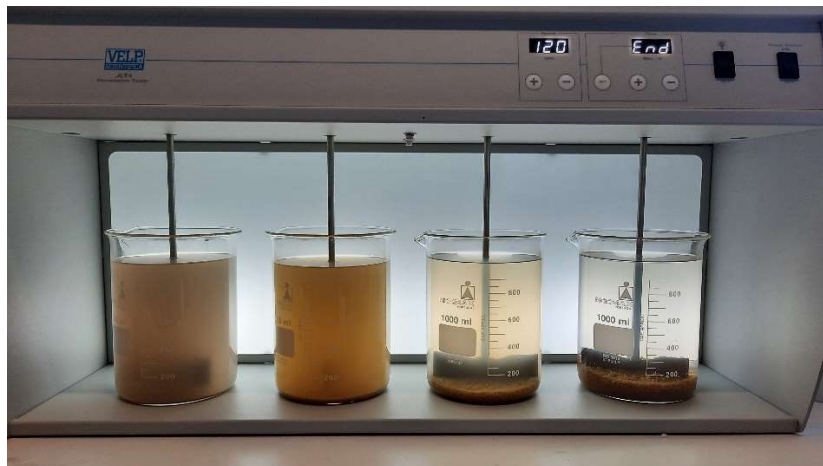
Figura 3.2– Teste de coagulação/floculação com equipamento Jar Test
