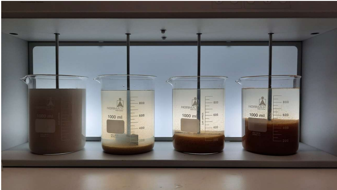
Figura c.3 – Amostras no final do jar test
