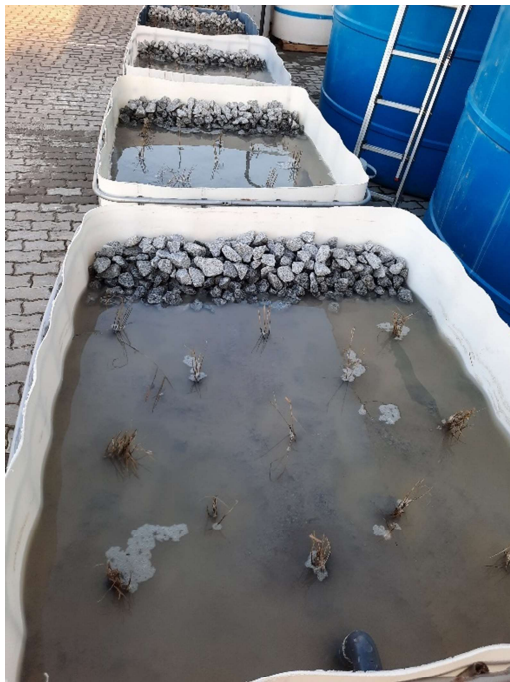
Figura 3.16 – Plantação dos caniços no leito
