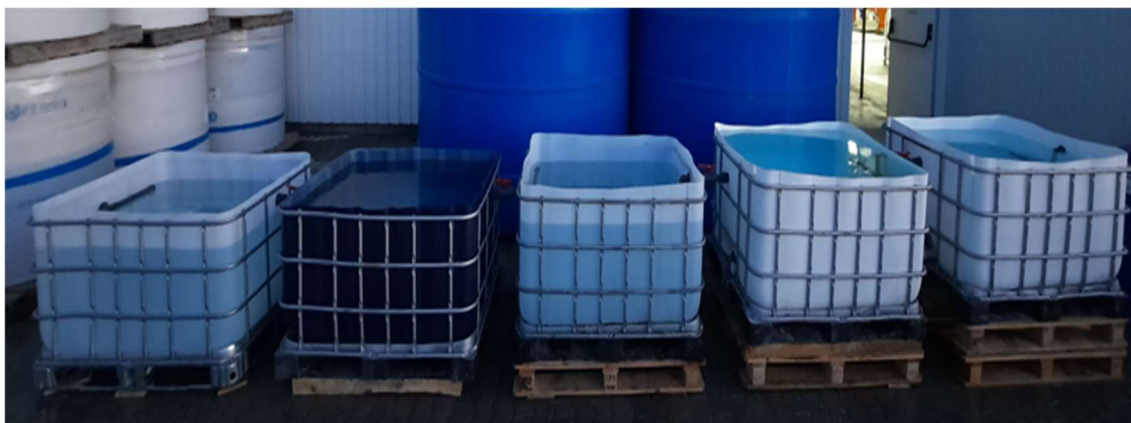
Figura 3.11 – Leito de macrófitas em teste hidráulico
