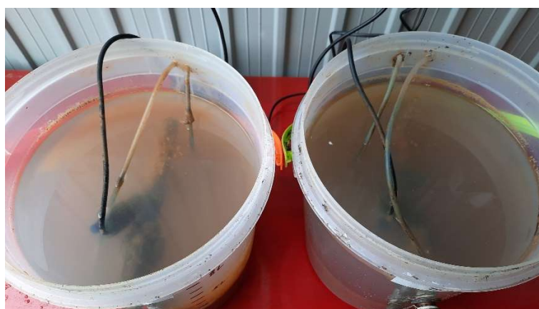
Figura 3.6 – Vista de cima dos SBR pilotos
