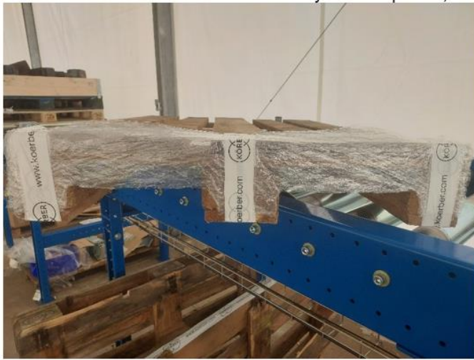
Figura 67 Palete com 5 camadas de plástico com 4 cm
