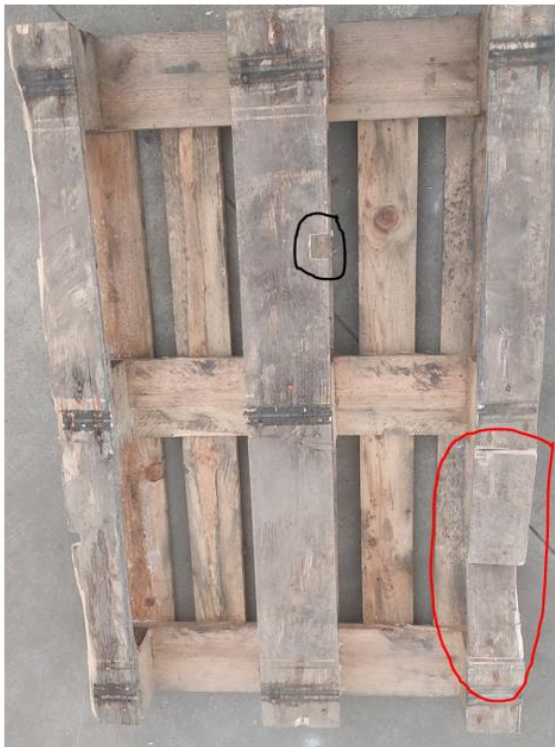
Figura 68 Palete com tábua partida e buraco 40x40 mm
