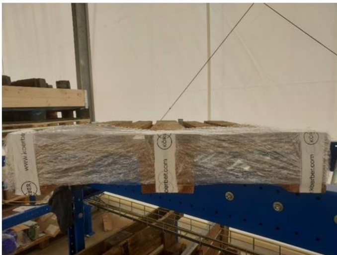
Figura 66 Paleta com 5 camadas de plástico a bloquear completamente o túnel
