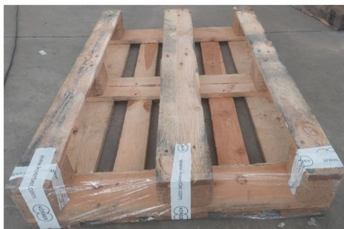
Figura 64 Paleta com uma camada de plástico a bloquear completamente o túnel
