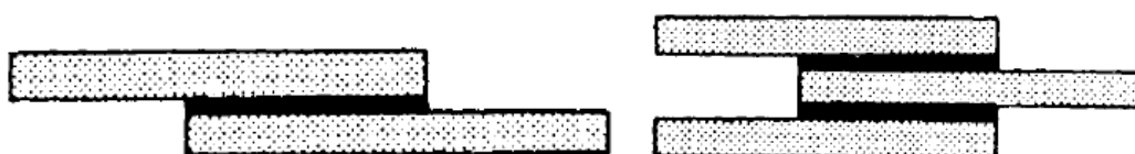
Figura 5 - Junta de sobreposição simples e dupla [2].
