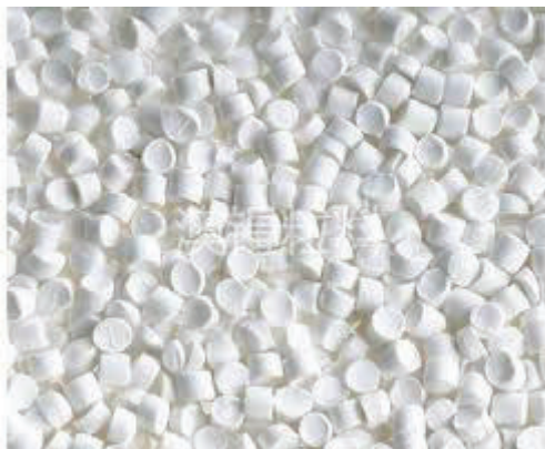
Figura 10 - Pellets PVC ( matéria prima usada na injeção ) [16]
