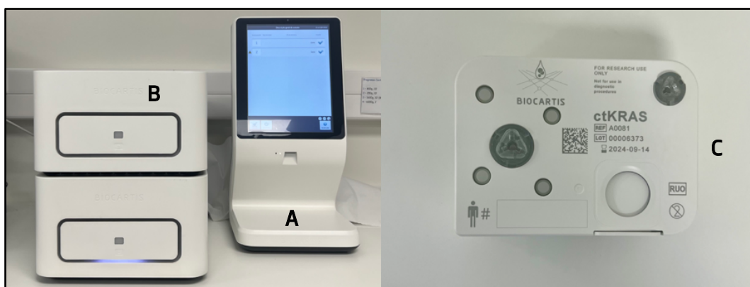
Figura 6 – Sistema Biocartis Idylla™. À direita a Idylla™ Console (A) conectada a dois Idylla™ Instruments (B) e à esquerda, um Idylla™ Cartridge (C).
