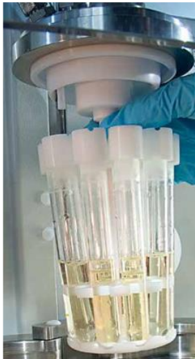
Figura 2.2 – Carrossel com tubos de quartzo usados no sistema de digestão
