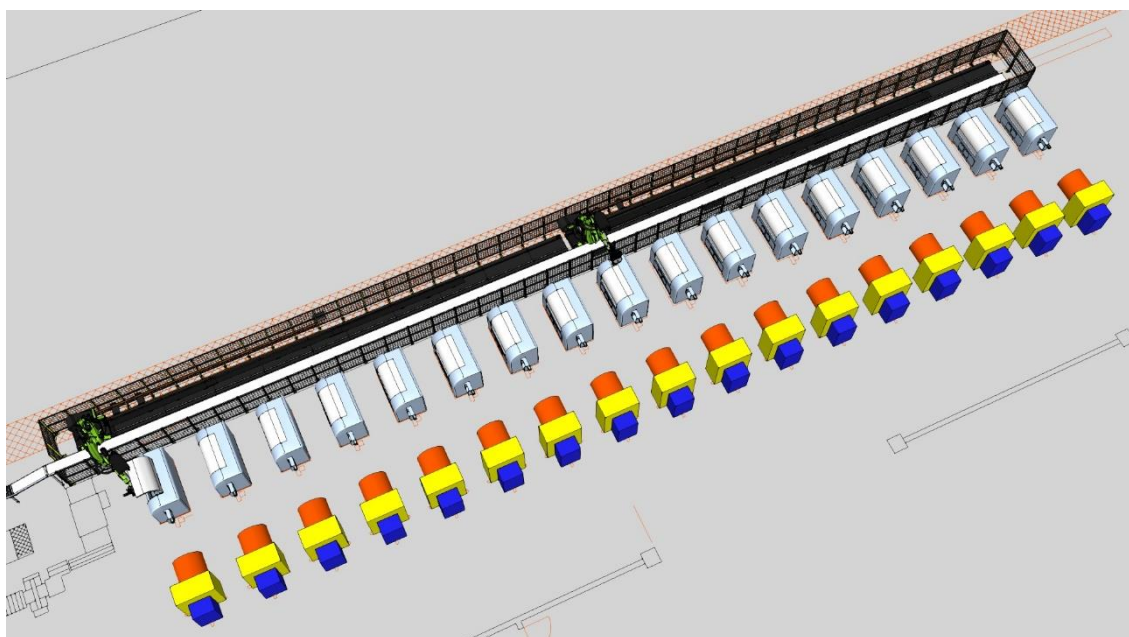
Figura 57- Linha idealizada com 17 bobinadeiras e respetivos alimentadores (Imagem proveniente de KUKA SIMPRO)
