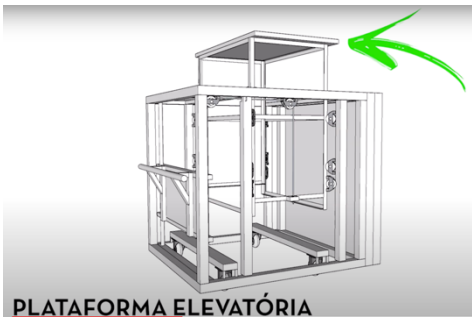
Projeto 3D do elevador de contra peso e demonstração das roldanas no elevador Imagem: Cenogravando
