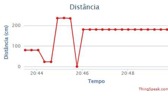
Figura 5.4: Análise dos Dados de Distância Coletados pelo Sensor Ultrassônico
