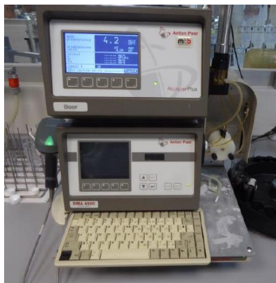
Figura 3. 3. Anton Paar DMA 4500 com a unidade da medição de álcool e densidade.
