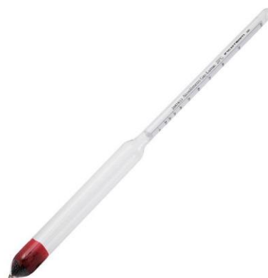
Figura 3. 2. Exemplo de alcoómetro utilizado para a medição de %(v/v) de álcool no destilado [33].
