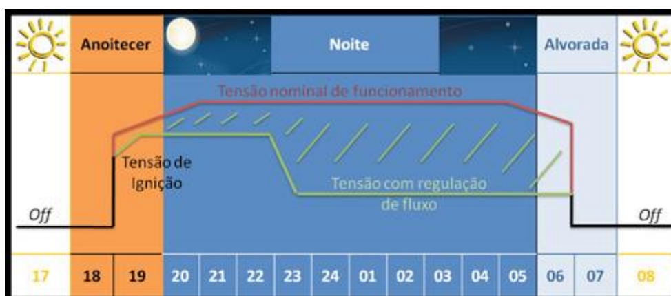
Figura 46 Funcionamento de um regulador de fluxo ao longo do período noturno
