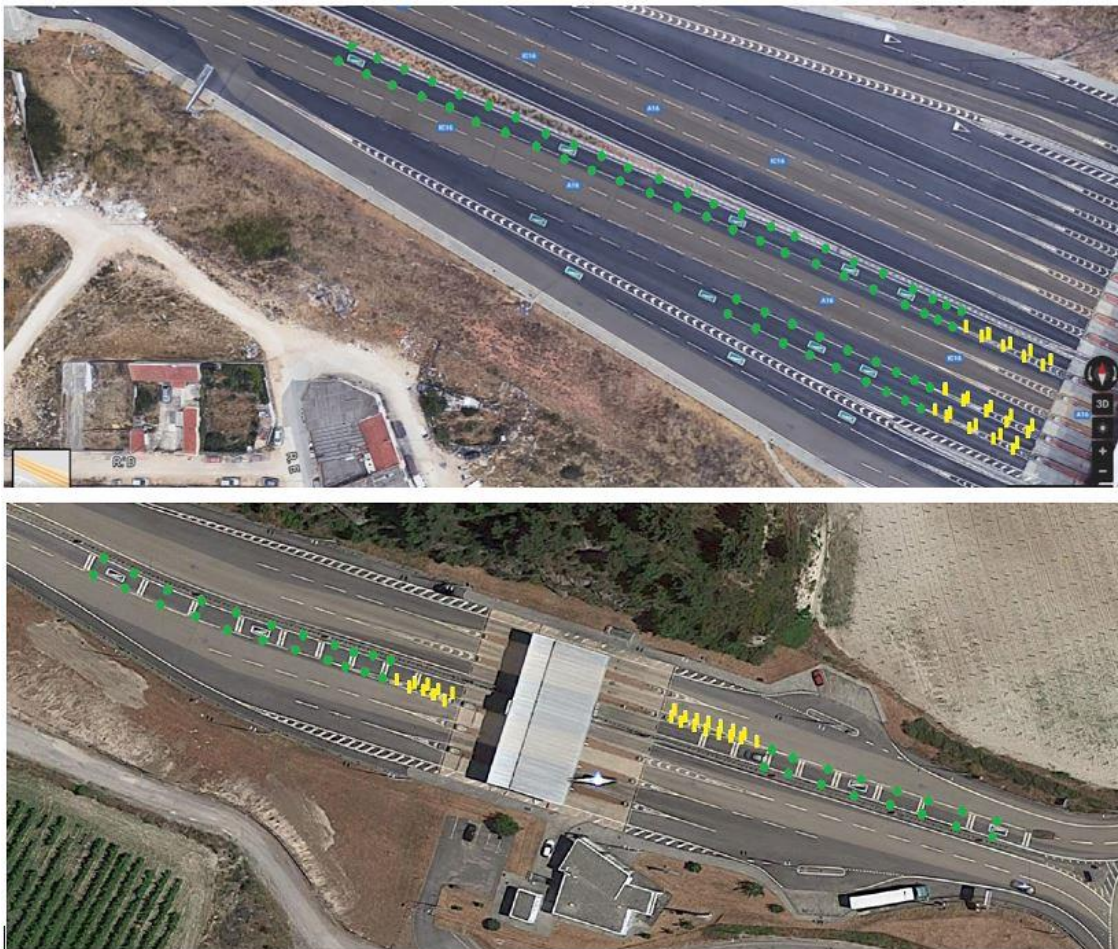
Figura 54 Esquemas de instalação de marcadores de LED em Belas (cima) e Castêlões (baixo)
