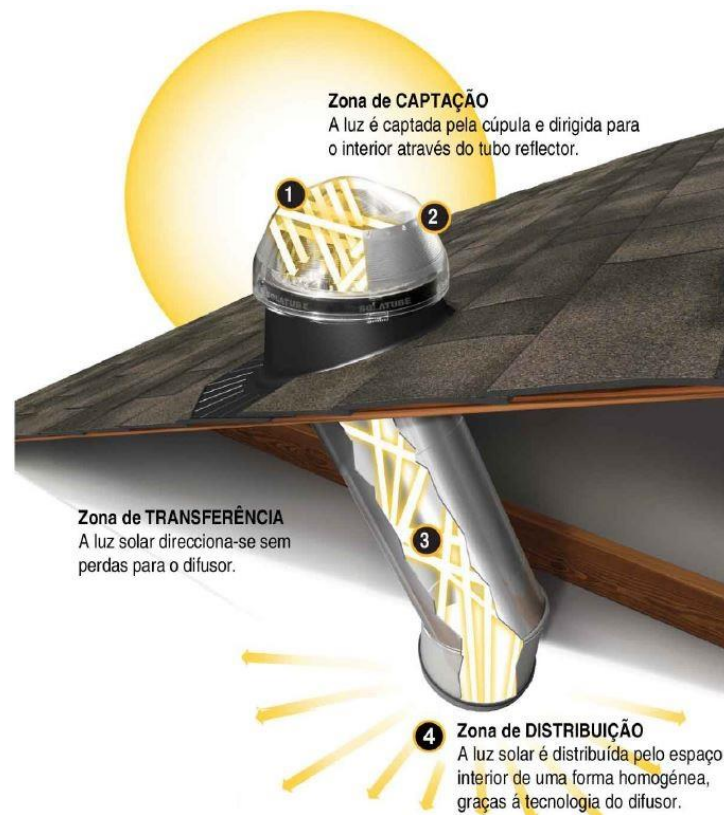
Figura 11 Esquema de funcionamento de um tubo solar
