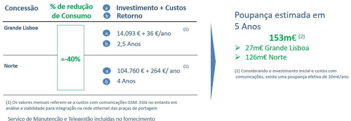
Figura 51 Poupança obtida com a instalação de reguladores de fluxo luminoso
