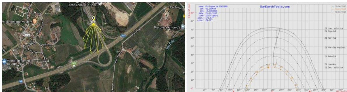
Figura 67 Trajetória do Sol e determinação do azimute na PT de EN206NO
