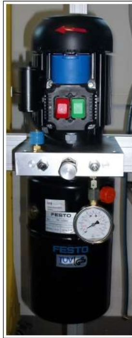
Figura 3.11 - Unidade de acionamento hidráulico
