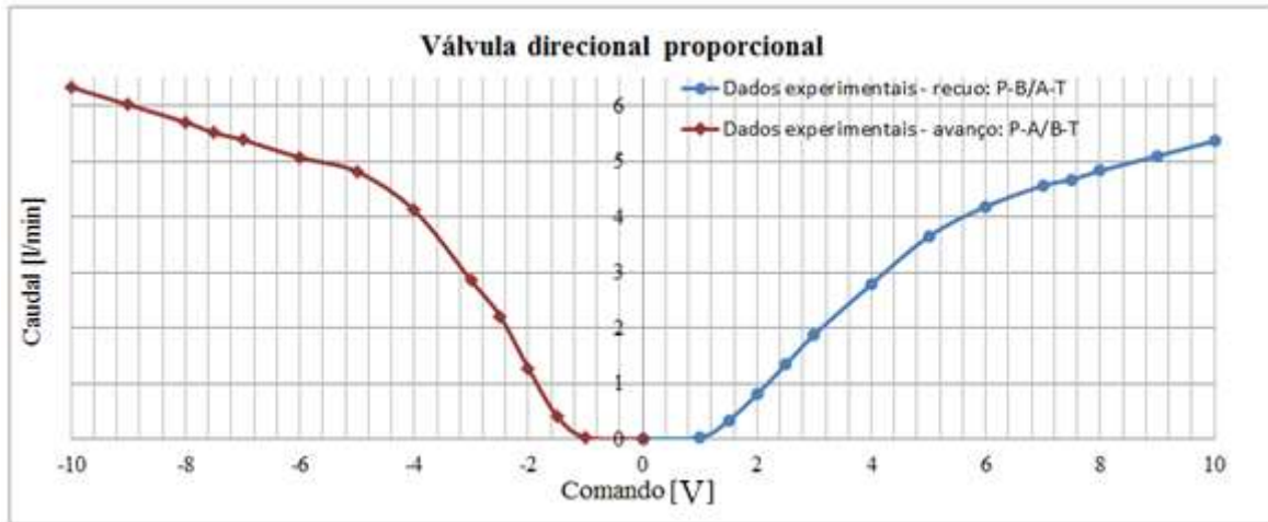
Figura 2.31 - Curva característica da válvula direcional proporcional Bosch Rexroth
