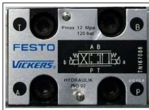
Figura 2.34 - Centro da válvula direcional proporcional Vickers
