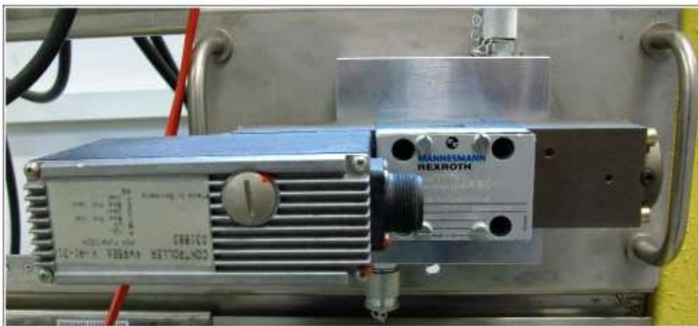
Figura 2.27 – Válvula direcional proporcional Bosch Rexroth
