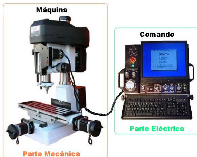
Figura 22- Constituição básica de uma máquina CNC
