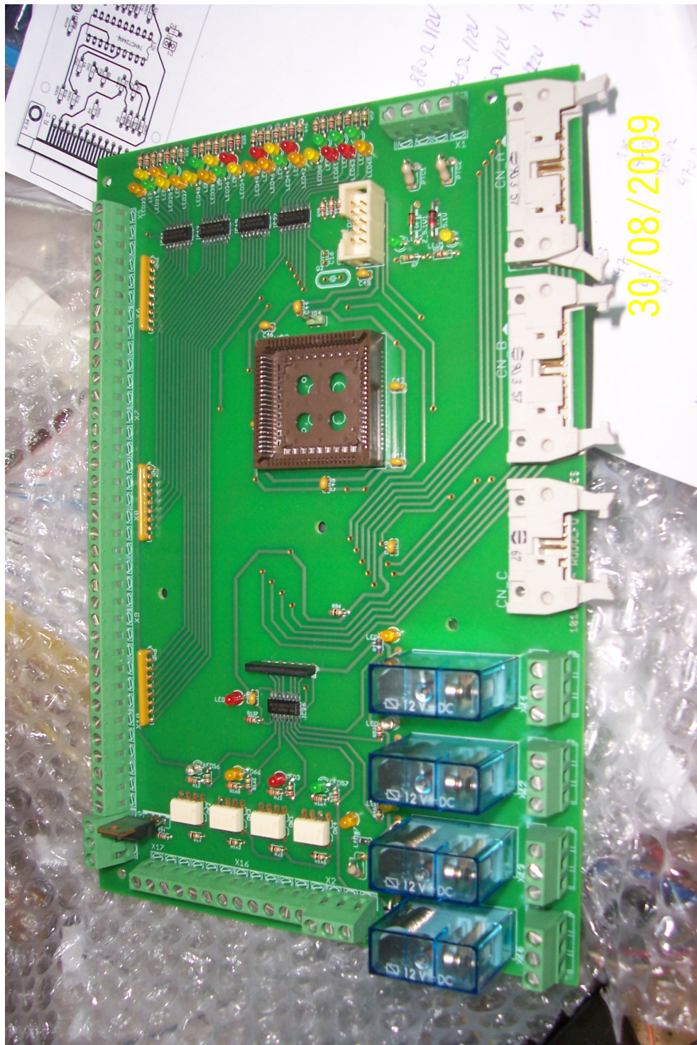
Figura 75- Foto da placa de entradas e saídas digitais (I/O Board)
