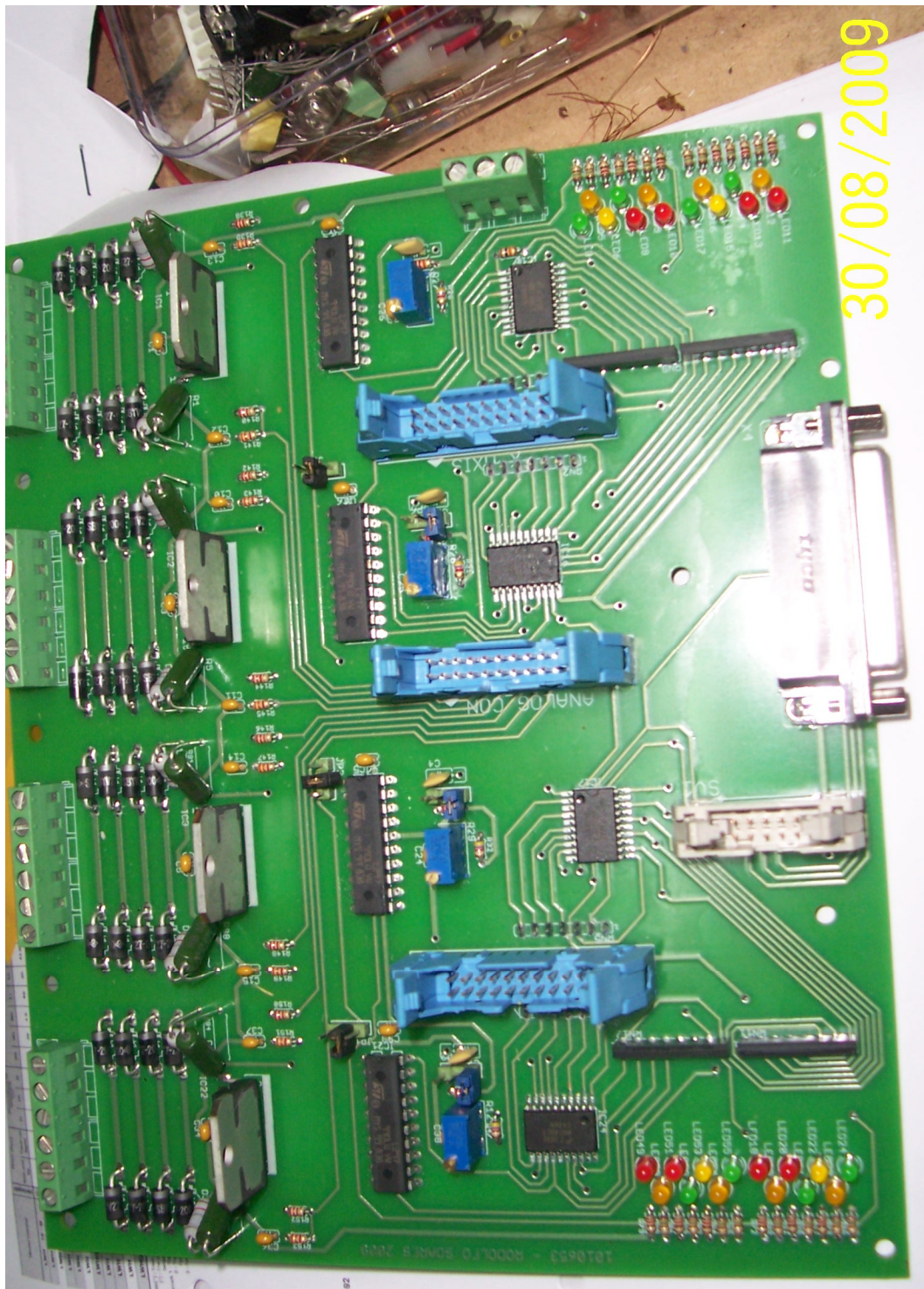
Figura 77- Foto da placa de controlo dos motores (Axis Board)
