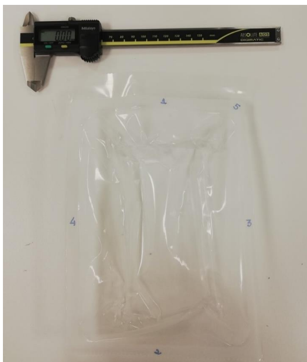
Figura D.2 – Embalagem com a marcação dos 5 pontos usados na medição da largura da selagem e paquímetro (utensílio de medição usado).
