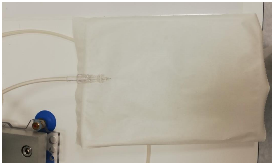
Figura 5.6 – Embalagem com agulha hipodérmica, exemplo de ensaio do teste de integridade.
