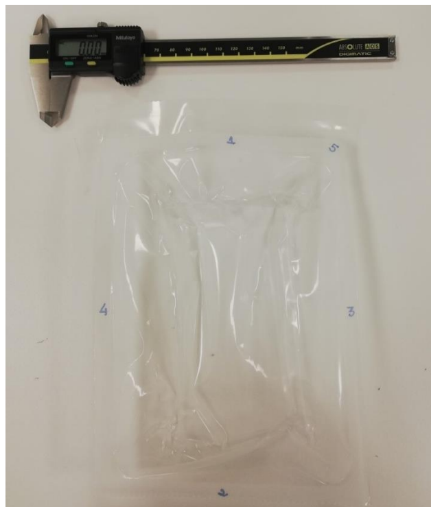
Figura 5.5 – Embalagem com a marcação dos 5 pontos usados na medição da largura da selagem e paquímetro (utensílio de medição usado).
