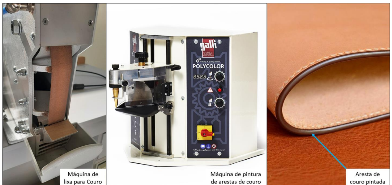
Figura 7 – Operações exigentes do ponto de vista operacional (Lixa e pintura)
