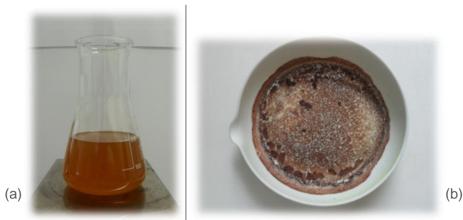
Figura 3.7 – Fotografias ilustrando a amostra de GS4 (a) e o resultado o teste de cinzas (b).
