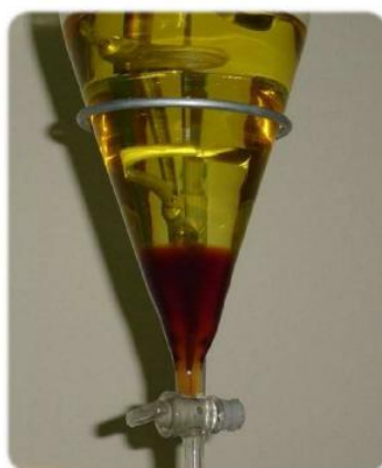
Figura 1.8 – Ilustração das duas fases formadas pela reacção de transesterificação que origina o biodiesel. [5]
