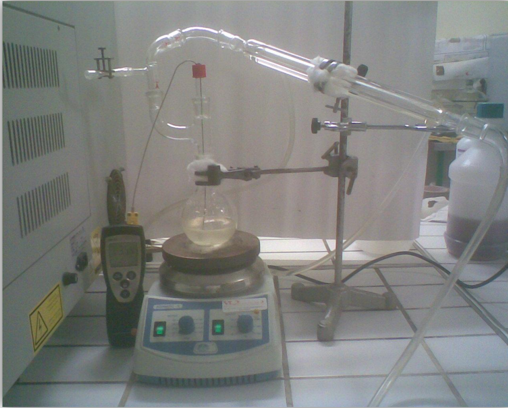
Figura 4.13 – Fotografia da instalação montada a nível laboratorial para a esterificação do glicerol com ácido oleico.
