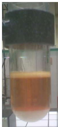
Figura 3.9 – Amostra GS5 sujeita a centrifugação, evidenciando a separação em 3 fases: após a adição de sulfato de alumínio.
